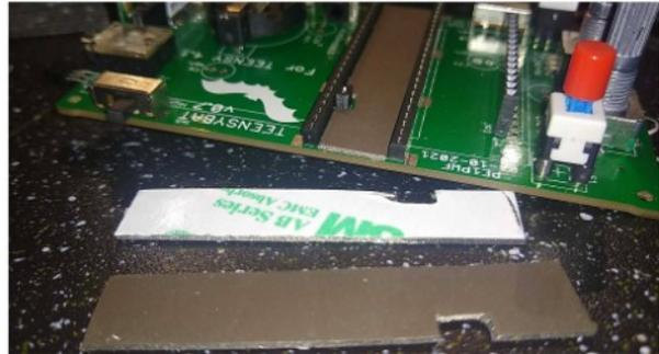
habe einige HF-absorbierende Folie unter dem Teensy und auch direkt unter der Metallabschirmung verwendet. Auf der Abschirmung ist nur wenig Platz, 0,5 mm dicke RF-Absorber ist in Ordnung, Sie können sehen, dass ich sogar einen Teil ausgeschnitten, wo es einen Kondensator berühren könnte. Je dicker das Material ist, desto mehr Signale kann es absorbieren. Man kann sogar versuchen, mehrere Schichten übereinander zu legen, um einen besseren GPS-Empfang zu erreichen.
