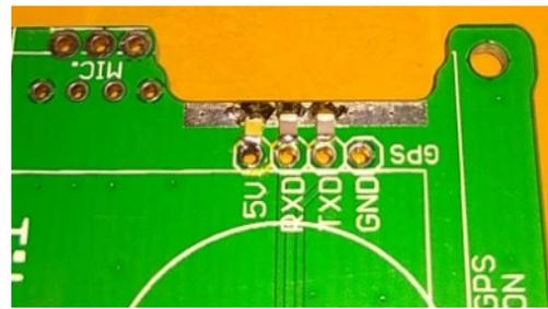
Zusätzliche Kondensatoren in der Nähe der GPS-Pads
